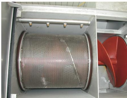
Besonderes Augenmerk in der Entwicklung wurde auf geringstmöglichen Verschleiß und hohe Betriebssicherheit gelegt. Aus diesem Grund arbeitet diese Anlage ohne verschleißanfällige innenliegende Bürsten zum Abreinigen des Siebkorb.
